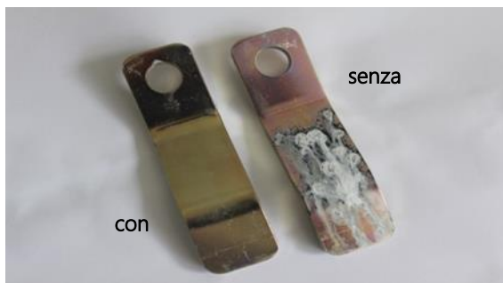
TOPAS 3100 + PROSEAL XZ 111 (+ PROSEAL Nanoadditiv) + SURFASEAL WL 150 dopo 840 ore in DIN EN ISO 9227
