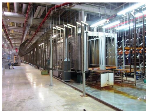
Panoramica dell'impianto di pretrattamento della Kesseböhmer: I vantaggi del processo di pretrattamento ottimizzato consistono in una migliore adesione della vernice e minore produzione di fanghi nonché nel risparmio energetico ottenuto tramite l'ottimale temperatura di esercizio.
