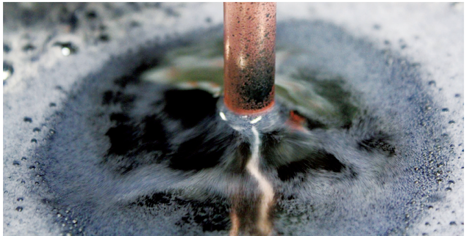
Wasserstoffentwicklung an einer Kupferkathode in einem Cr(III)-Elektrolyten
